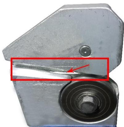
В процессе эксплуатации появляется износ подшипников направляющих роликов ножа. При выявлении подклинивания или отсутствии вращения, появлении «свободного расшатывания» на крепёжном винте, износа контура облегания поверхности направляющих планки, ролики необходимо заменить.
